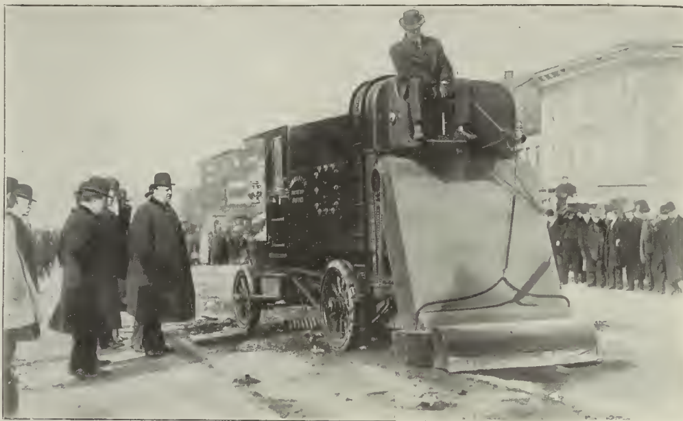
Nueva York.—Nuevo tipo de automóvil para regar y barrer á la vez las calles. (De fotografía de «Argus Photo Reportage.»)
